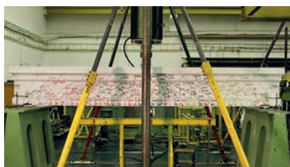
Zaťažovacia skúška pre zosilnené nosníky – skúšobná dráha pre sekundárnu etapu skúšok; teoretická predikcia porušenia; reálne šmykové porušenie.
