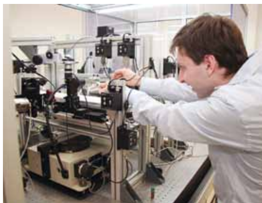
Zariadenie Lab – GISAXS, ktoré je súčasťou komplexu laboratórií na výskum nanotechnológií a nanoštruktúr vo Fyzikálnom ústave SAV.
