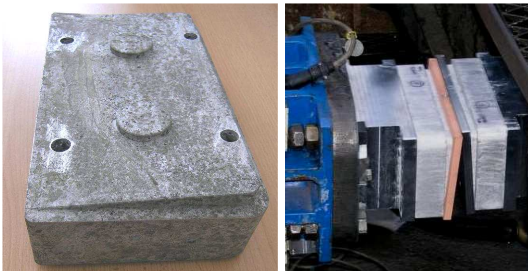
Súčiastka z hliníkovej peny a nárazníková zostava pred nárazovou skúškou
