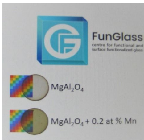
Obr. 1. Vzorky transparentného \text{MgAl}_2\text{O}_4 and Mn-dopovaného \text{MgAl}_2\text{O}_4 pripraveného metódou SPS pri teplote 1250^\circ\text{C} a axiálnom tlaku 80 MPa.
