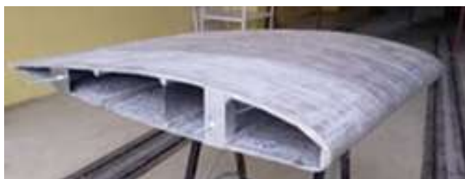
Obr. Finálny prototyp z hliníkovej peny.
