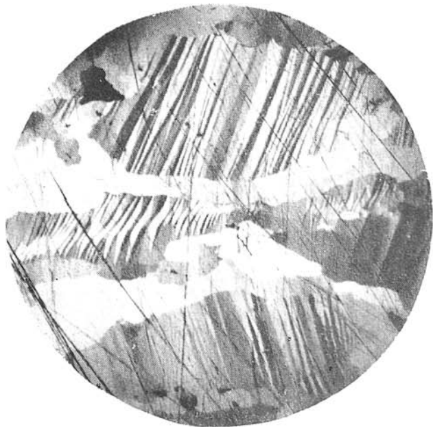
Obr. 1. Granoblastická štruktúra typická pre rekryštalizované antimonitové individúá. Nikoly +, nábrus zv. ca 40X. — Obr. 2. Jednosmerným tlakom deformované antimonitové zrnká s prevládajúcim pretiahnutým tvarom, na ktorých pozorovať dobre vyvinuté translačné lamely, tretieho a štvrtého typu, orientované paralelne so smerom pôsobenia tlaku. Nikoly +, nábrus zv. ca 160X. Mikrofoto Schwartz.
