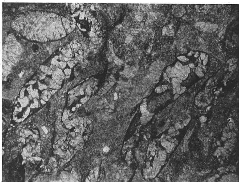
Obr. 1. Ilitové oolity, deformáciou vytiahnuté do tenkých šupín. Biele zrnká patria klastickému jemne piesčitému kremeňu. V ľavom hornom rohu jemnozrnný siderit. Spodný lias Belanských Tatier; Ždiarska Vidla. Zv. 40X. — Obr. 2. Zatláčanie ilitových oolitov sekundárnym kalcitom. Lokalita ako v predošlom. Zv. 43X. Foto Mastihuba.
