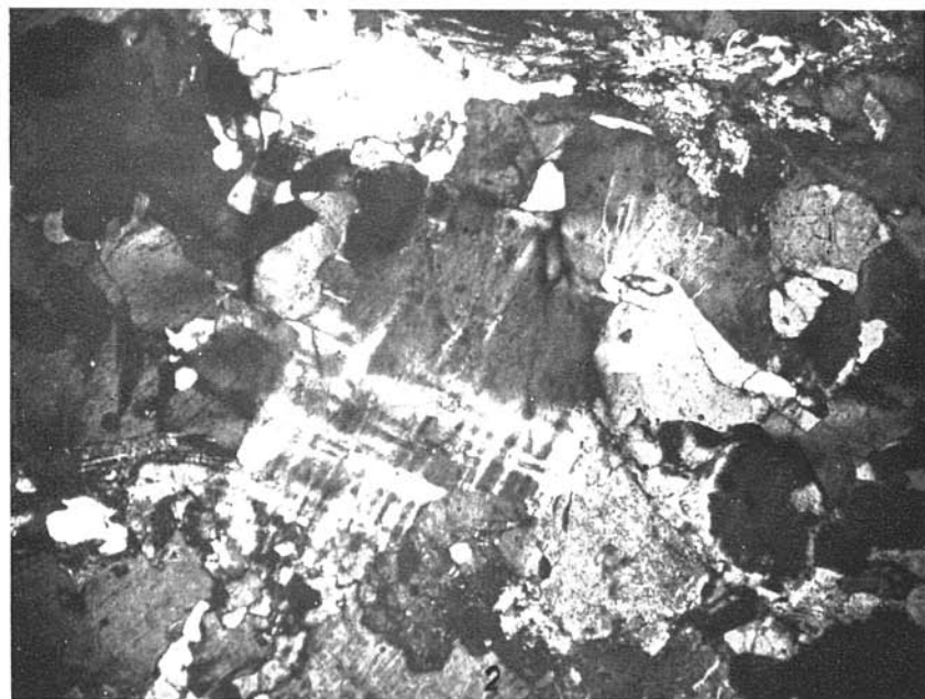
Obr. 1. Aplitická ortorula — blastogranitická štruktúra. Sericitizované plagioklasy, dobre zachované K živce. Vpravo hore myrmekit. Zväč. 23×. Nikoly ×. — Obr. 2. Porfiroblast mikroklinu v ortozložke zo žuloruly. Nikoly ×. Zväč. 23×. Mikrofoto O s v a l d.
