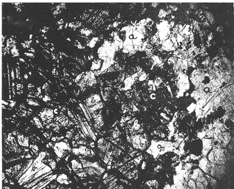
Obr. 1. Koncentrácia monoklinických pyroxénov v hadci, Rudník. Jeden nikol, zväčšené 60 \times . a-serpentin, b-monoklinické pyroxény, c-rudný pigment.
