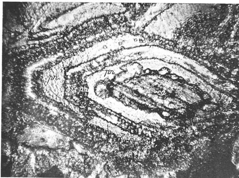
Obr. 1. Chloriticko-kremenná mandľa. Striedanie koncentrických vrstvičiek peninu (pn) s kremeňom (Si). Stred vyplnený kalcitom (ca). Nikoly málo skrižené, zväčšené 85×.
