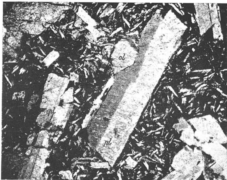
Obr. 1. Metafýrový porfýrit. Idiomorfný olivín vyplnený sekundárnymi chloriticko-serpentinickými minerálmi. Plagioklasy intratelurickej (pl) a efuzívnej generácie. Skrižené nikoly, zväčšené 95×.
