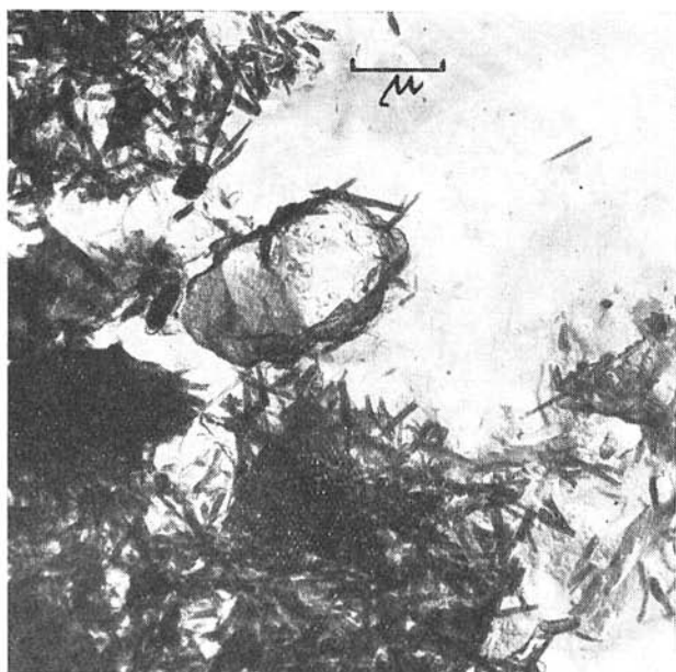
Abb. 30. Rožnava, Mária baňa. Allophan mit Halloysit. Demonstrierung der Methode des selektiven Lösens. 10 600 \times vergr.
