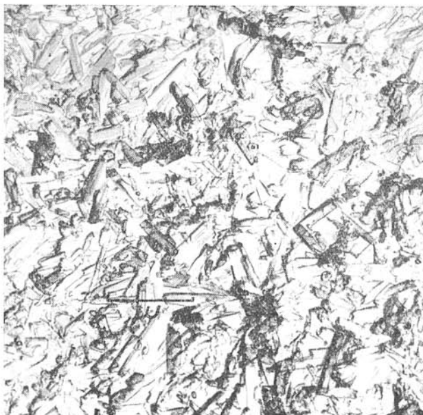
Abb. 10. Biela Hora. Unregelmässige Orientierung von Halloysitkristallen. Einstufiger Abdruck der Bruchfläche, 16 800 X vergr.
