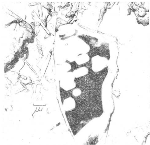
Abb. 1. Unanov bei Znojmo. Durch Strukturätzung (vorzeitiger Abbruch der Lösung in HF) erschienen auf dem unregelmässig umgrenzten Kaolinaggregat pseudo-hexagonale Formen. 1-stufiger Abdruck der Bruchfläche, 7 000 \times vergr.
