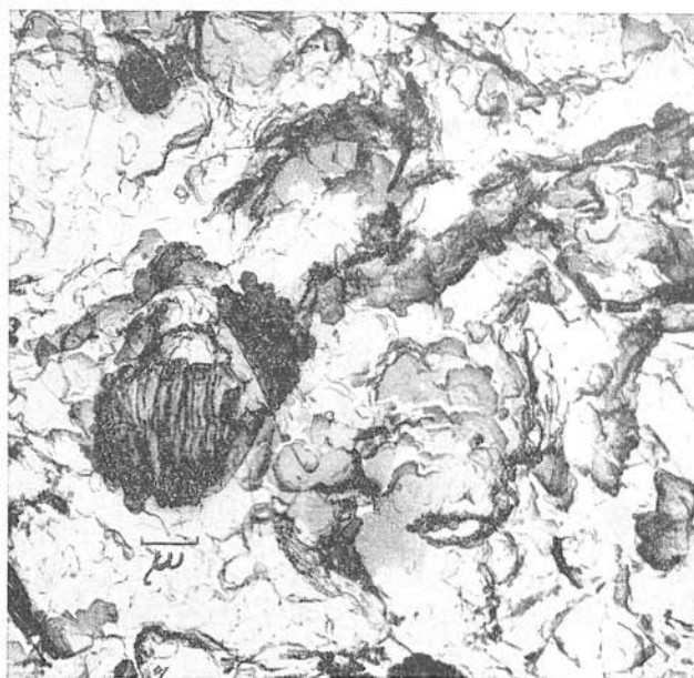
Abb. 3. Sedlec. Ungeordnete Orientierung von Aggregaten des Kaolinites. Einstufiger Abdruck der Bruchfläche 7 000 \times vergr.
