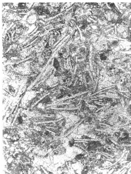
Abb. 1. Kalkstein mit Bruchstücken juveniler Lamellibranchiatengehäuse. Manin-Enge, Dünnschliff Nr. 2475, vergr. 43 X. Foto K. Machaj.
