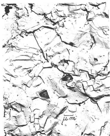
Abb. 15. Biomikrit mit ungleichmässig grossen angularen Körnern (organogener Detritus). Manin-Enge, zweistufiger Abdruck der natürlichen Bruchfläche, Vergr. 5250 X, Foto M. Harman.
