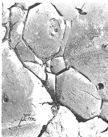
Abb. 5. „Protoglobigerine“-Kalkstein. Mikrosparit, den Kern „Protoglobigerine“ bildend. Manin-Enge, zweistufiger Abdruck der natürlichen Bruchfläche. Vergr. 3450 X. Foto M. Harman.
