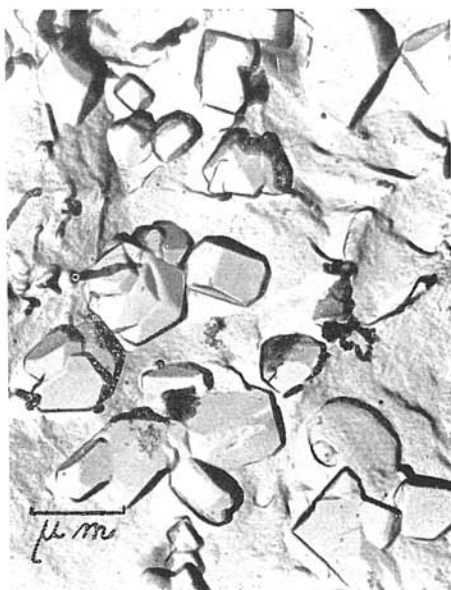
Abb. 8. Radiolarienkalk, Idiomorphe Kristalle neugebildeten Kalzits, Berg Vršatec, zweistufiger Abdruck der natürlichen Bruchfläche, Vergr. 12 600 X, Foto M. Harman.
