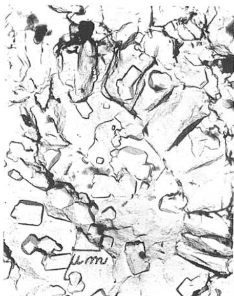
Abb. 9. Radiolarienkalk, (?) Nannoconus sp. mit Erscheinungen sekundärer Rekristallisation. Zweistufiger Abdruck der natürlichen Bruchfläche. Vergr. 7950 X. Foto M. Harman.
