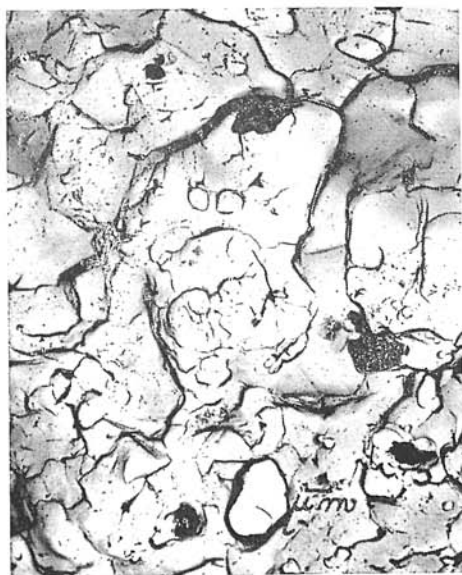
Abb. 11. Saccocoma-Kalk. Mikrit mit abgerundeten Körnern. Manin-Enge. Zweistufiger Abdruck der natürlichen Bruchfläche. Vergr. 3450 X. Foto M. Harman.
