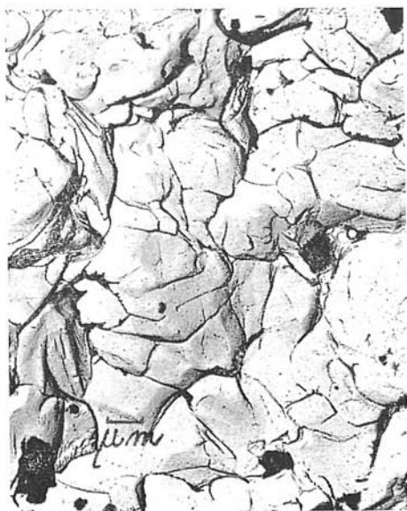
Abb. 12. Globochaeten-Kalk. Mikrit mit organogenem Detritus. Manin-Enge, zweistufiger Abdruck der natürlichen Bruchfläche. Vergr. 5250 X. Foto M. Harman.
