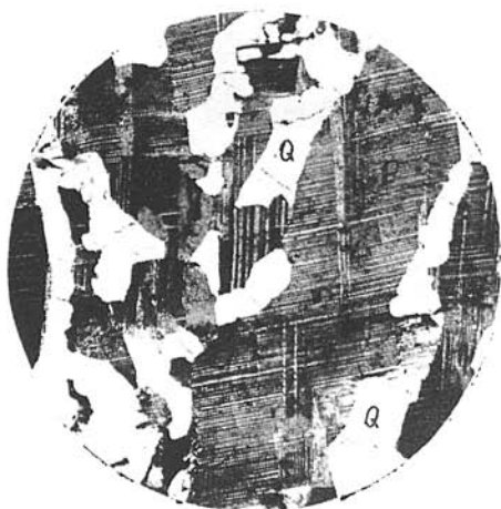
Abb. 13. Schriftgranit, erster Typ. Plagioklas (P) nach dem Albit- und Periklin-Gesetz verzwillingt. Quarz (Q) bildet unregelmässig begrenzte Körner. Probe Nr 583. Vergr. 15 X, Nic. X. Foto L. O s y a l d.
