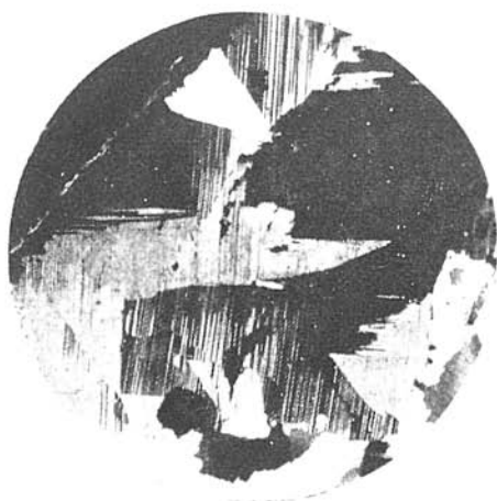
Abb. 9. Sekundäre Deformations-Zwillingsbildung von Plagioklas aus der Feldspat-Quarz-Glimmer-Zone des Pegmatits. Probe Nr 102. Vergr. 9 X. Nic. X. Foto L. Osvald.
