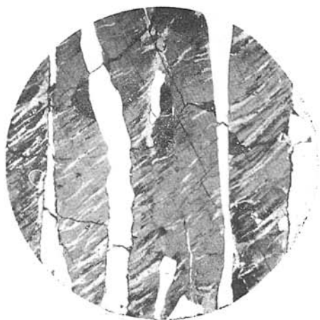
Abb. 15. Scharfe Beendigung der Perthit-verwachsungen an ihrem Kontakt mit Quarz-ichthyoglypten. Schriftgranit des zweiten Typs. Probe Nr 942. Vergr. 5 \times . Nic. \times . Foto L. Osvald.
