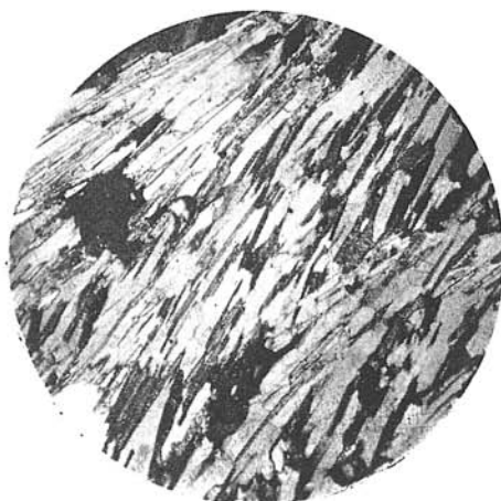
Abb. 21. Fächer-Muskovit, gebildet durch Verwachsungen von Muskovit und Quarz. Probe Nr. 70/3. Vergr. 18 X, Nic. X. Foto L. Osváld.
