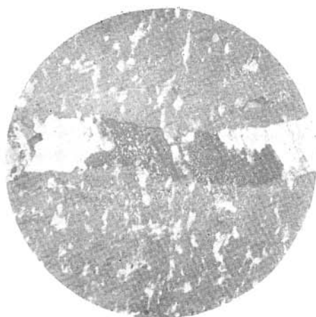
Abb. 17. Quarz-Ichthyoglypt mit Aggregat-aufbau, von segregations-metasomatischen Perthiten durchdrungen. Schriftgranit-Zone, Probe Nr 75 2, Vergr. 18 X, Nic. X, Foto L. OsvaId.
