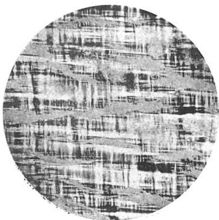
Abb. 18. Spindelförmige Segregations-Perthite, orientiert nach (100), Mikroclin-Perthit aus der Block-Mikroclin-Zone, Schnitt nach (001), Probe Nr 173, Vergr. 35 \times , Nic. \times , Foto L. Osváld.
