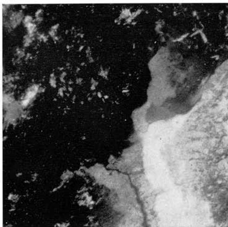
Abb. 4. Seritisierter zonarer Plagioklas älterer Generation. Probe No 23/63, vergr. 80X, Nikol X. Foto M. D y d a.
