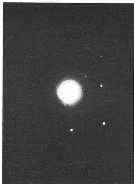
Abb. 8. Zentrum der Mylonitzone, unregelmässig begrenzter Kalzitkristall, Einkristall-Beugungsaufnahme.
