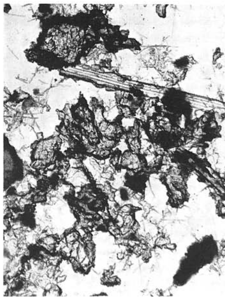
Abb. 6. Zentraler Teil der Mylonitzone, grosse prismatische geriffelte Aragonitkristalle, unregelmässig begrenzte, Kalzit, Tonminerale. TEM, selektive Lösung, 7000 \times vergr.
