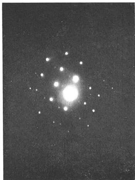
Abb. 9. Unmittelbare Umgebung der Mylonitzone, Einkristall-Beugungsaufnahme eines kleinen prismatischen Aragonitkristalls, zyklische Verwachsung, die linke Seite mit diffusen Punkten ist schräg zum Elektronenstrahl gestellt, der linke Teil (von der Mitte) liegt senkrecht zum Elektronenstrahl.
