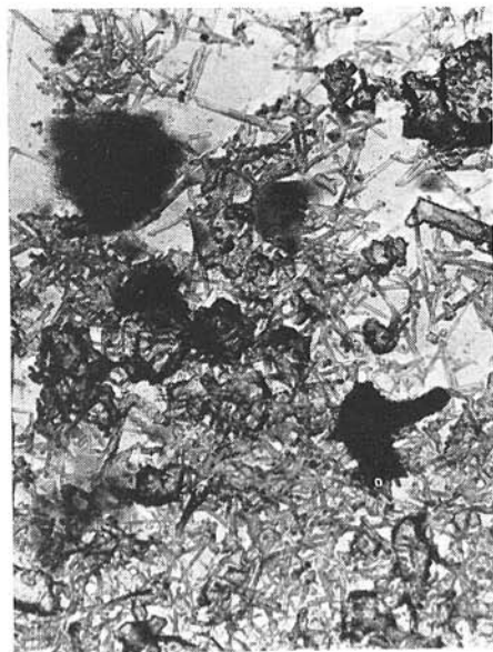
Abb. 5. Randpartie der Mylonitzone, kleine Nadelchen Aragonits, unregelmässig begrenzter Kalzit, Tonminerale. TEM, selektive Lösung, 7000 \times vergr.
