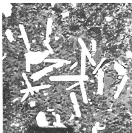
Abb. 1. Im Gestein verstreute langgestreckte Kristalle Montroseits. Bild der reflektierten Elektronen (Komposition) in der Elektronenstrahlmikrosonde. 300fache Vergrößerung, Photo J. Kristin.
