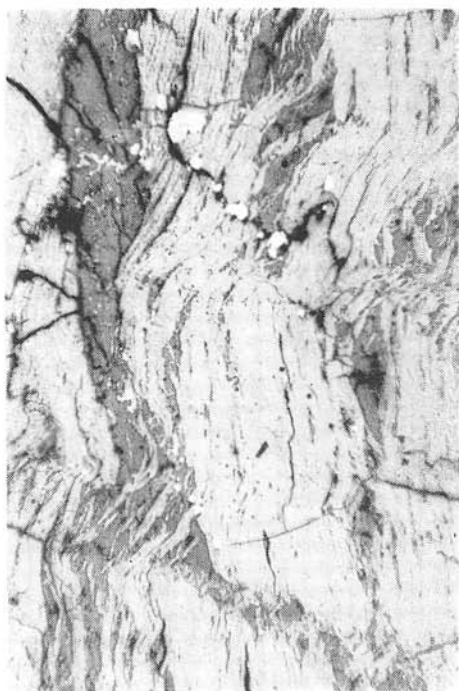
Фиг. 14. Тонко переслоенный обломок обугленной флоры, который вдоль и поперек слоистости заполнен кремнием. Зерна пирита (светлые) рассеяны в нем. 1 николь, увеличение 80 \times , фото И. Ройкович.
