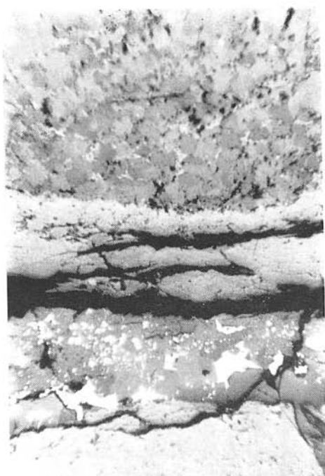
Фиг. 12. Деталь поперечного разреза обугленной ветки дерева, показанной на фото 11. Нижняя часть фотографии представляет окраинную часть ветки. Ее центральная часть образована тонкозернистыми карбонатами. По направлению к окраинам можно наблюдать обугленное дерево, окремененное, при чем кремний сопровождается галенитом и халькопиритом. 1 николю, увеличение 80×, фото И. Ройкович.
