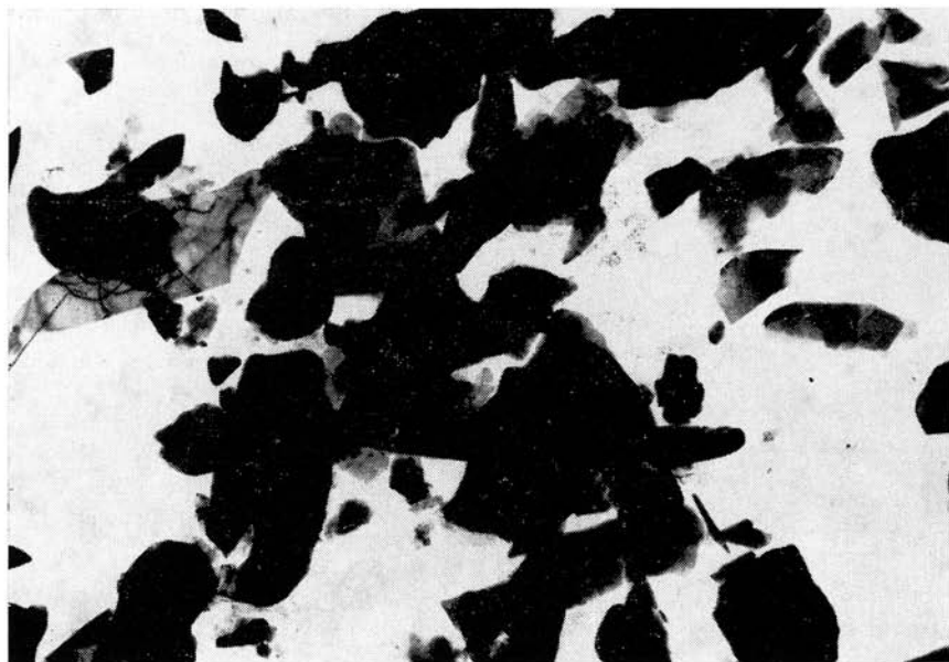
Abb. 9. Tonglimmer und ursprüngliche Minerale, Probe 5 — Borinka, Suspension, 3000 \times vergrößert
