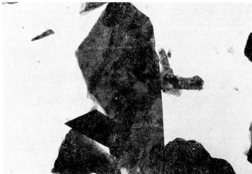
Abb. 6. Grosser, tafeliger Kristall eines Tonglimmers, Probe Nr. 5 — Borinka, Suspension, 4500 \times vergrössert
