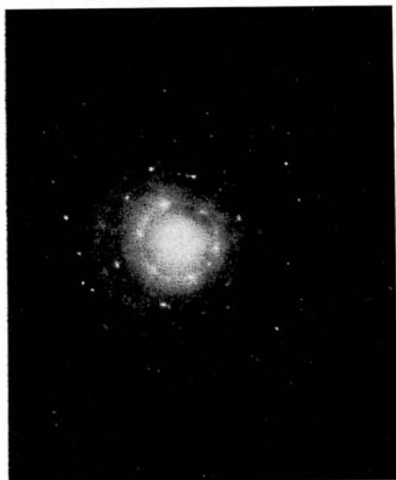
Abb. 14. Beugungsbild des Montmorillonits aus Abb. 12 (Probe 7 — Harmónia)
