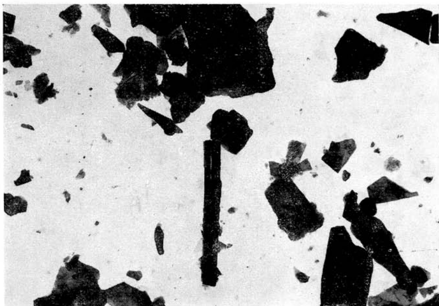
Abb. 17. Halloysit (?), Tonglimer, ursprüngliche Minerale, Probe 4 — Jur bei Bratislava, Suspension, 3000 \times vergrößert
