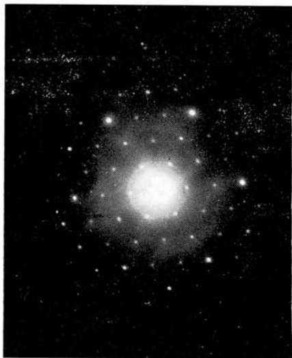
Abb. 8. Beugungsbild eines Tonglimmers aus Abb. 6 (Probe 5 — Borinka)
