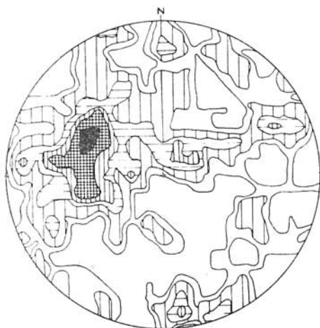
Abb. 13. Diagramm der Pole der Klüfte der Migmatite zwischen Čavoj und Okrúhly vrch. 150 Messungen; 6—4—3—2—1—0,5 %.
