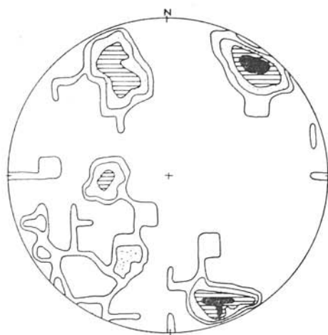
Abb. 10. Diagramm der Pole der Klüfte aller Gesteinstypen zwischen dem Tal Kšinská dolina und Čierna Lehota. 60 Messungen; 8,5–5–2,5–0,5 %.
