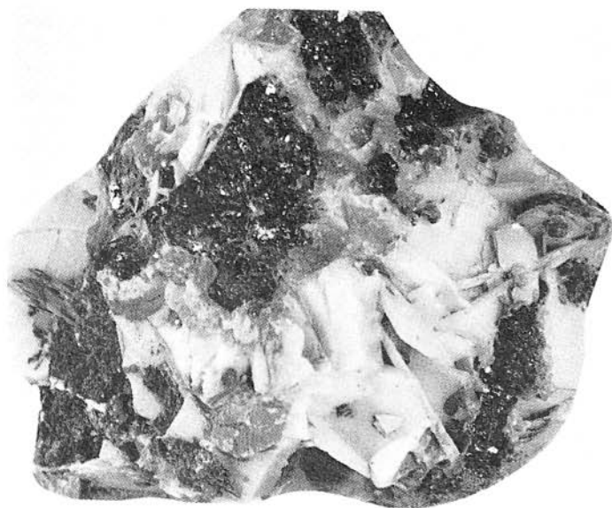
Рис. 8. Текстуры руд свинцово-цинковых месторождений в скарнах. Дальнегорский район. Полир. штуфы, натур. вел: Пояснения: а) Геденбергитовый скарн с вкрапленностью сфалерита и прожилкообразными обособлениями галенита; б) Друзы галенита, сфалерита и кальцита на кварцевой основе.
