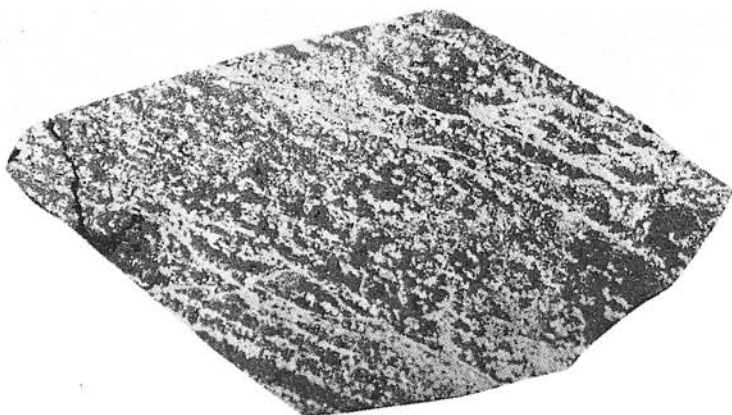
Рис. 5. Тонкополосчатые текстуры („бурундуки“) галенит-сфалеритовой руды (м-ние Благодатское, Сарданское). Полир. штуфы, натур. вел.
