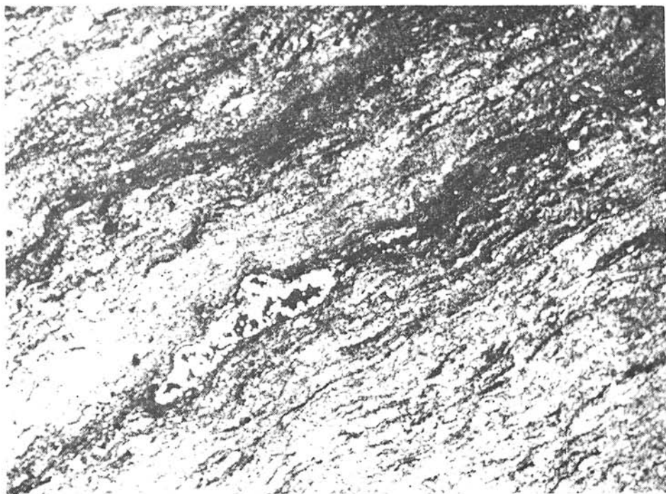
Рис. 1. Формы «стрессовых обособлений» кремнезема, углеродистого вещества и пирита в дислоцированных фтанитах из зон надвигов. Увеличение 90; без анализатора.
