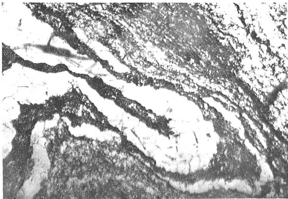
Рис. 2. Морфология кварцевых «стрессовых» микротекстур в углеродистых метасиликатах в условиях пластической деформации породы. Увеличение 90; без анализатора.
