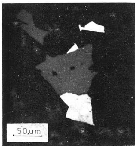
Рис. 11. Круглое выделение электрума (ярко-белый) в зерне галенита (светло-серый), срastaющемся с халькопиритом (белый) и сфалеритом (темно-серый) в интерстиции кварца (черный).
