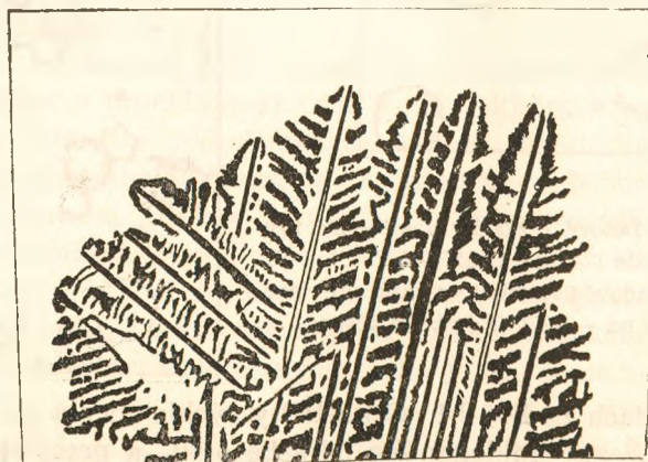
Obr. 5. Paprad'ový okraj ľadovej doštičky vzniknutej v prechladenej vode až na -3^{\circ}\text{C} (4-krát zväčšené).
