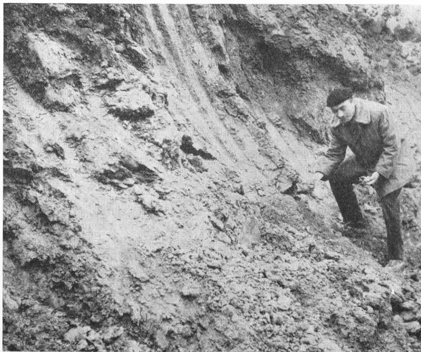
Obr. 4. Silne rozdrvené ílovce v okolí šmykovej plochy hlavného zosuvu na dne kanála v 15,150 km. Na obrázku nezreteľná šmyková plocha na kóte 312,0 m n. m.
