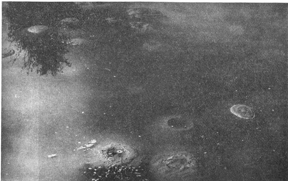
Obr. 6. Drobné vývery za hrádzou s vynášaním jemného piesku — sufózne javy. (Maximálny priemer zrna piesku 1 mm, asi 50 % priemer zrna 0,1–0,25 mm.)
