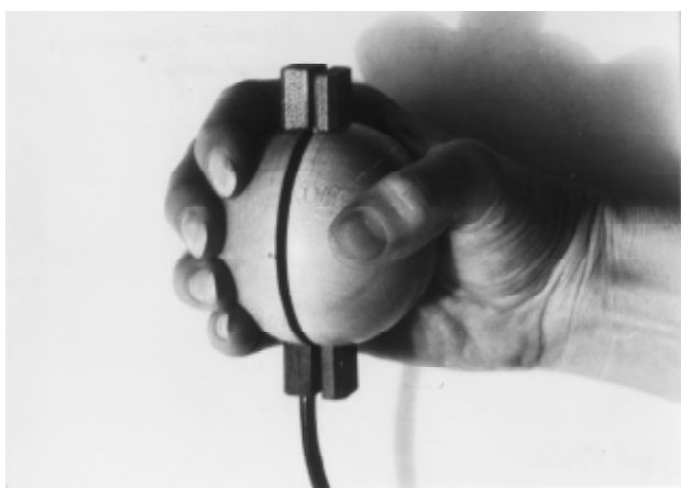
Obr. 2. Gulovité úchopové teleso. Fig. 2. Spherical grip body.
