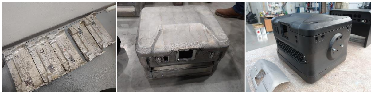
Obr. Samostatné časti skrinky laserového projektora (vľavo), kompletná skrinka laserového projektora (v strede) a skrinka po povrchovej úprave (vpravo).
