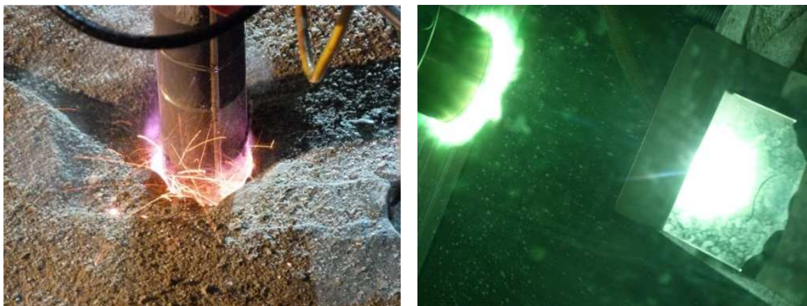
Testovanie vyvinutých elektród pre spoločnosť GA Drilling Bratislava pri vŕtaní hornín.
